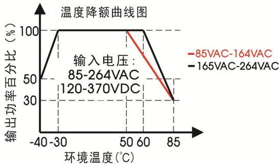
注：1.对于输入电压为 85 - 100VAC/120 - 140VDC 需在温度降额的基础上进行输入电压降额；
