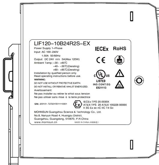
注: 在设备负载长时间地超过额定功率的 50% 时, 建议保留顶部 20mm、底部 20mm、左右各 5mm 的间隙。如邻近的设备是热源(例如另一个电源), 则将此间隙增大至 15mm。
